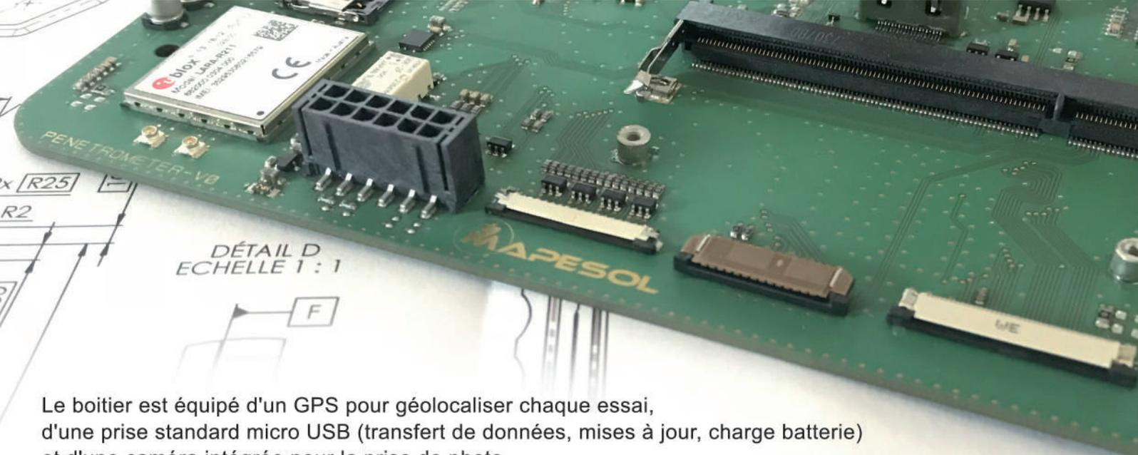
Le boîtier est équipé d'un GPS pour géolocaliser chaque essai, d'une prise standard micro USB (transfert de données, mises à jour, charge batterie) et d'une caméra intégrée pour la prise de photo. L'écran couleur 7" permet une visualisation en direct des pénétrogrammes et des courbes de références.
