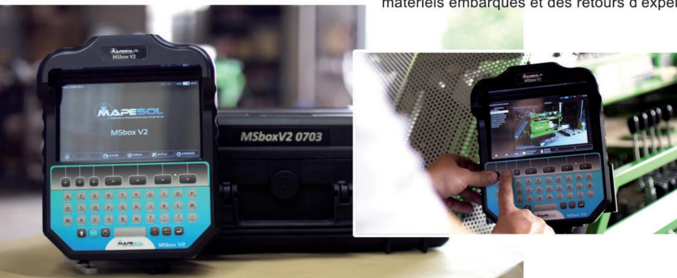
Ce développement a notamment abouti à un boitier d'acquisition équipé d'un logiciel d'exploitation optimisé pour un fonctionnement avec des boutons contextuels; ceci afin de se passer de la technologie tactile particulièrement «non adaptée» aux environnements d'utilisation des pénétrömètres.
